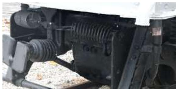
La suspension, assurée par ressorts à lames, permet au locotracteur de circuler sur des voies de qualité moyenne sans que la charge n'excède la charge maximale du système Decauville (3 500 Kg). Le freinage est assuré électriquement par une résistance de freinage montée sur le châssis et par un frein mécanique classique au niveau des essieux. La vue de droite montre une des barres d'attelage et ses chaînes de sécurité.
