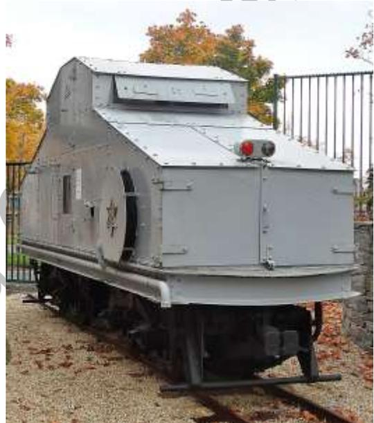
Sur la plaque ronde de l'orifice de refroidissement du moteur, l'étoile à 6 branches symbolique du constructeur.
