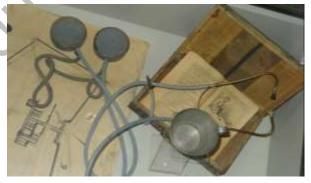
Le matériel (2 appareils) est rangé dans un coffret de bois aux accessoires de laiton marqué GEOPHONES S.P.<sup>2</sup>. Une notice sommaire est collée à l'intérieur du couvercle.
