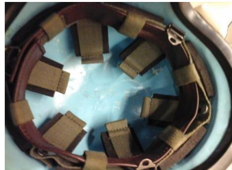
Ce casque est réalisé en fibre Spectra, un matériau composite en polyéthylène unidirectionnel renforcé conçu à l'origine par l'entreprise américaine Allied Signal. Ce matériau, aussi résistant que le kevlar est plus souple et plus léger que ce dernier.
