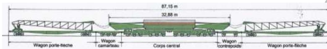
En position travail, il mesure 70,60 m.. L'ensemble flèches peut pivoter latéralement sur un angle de 10 degrés. Les flèches sont mues par des vérins de 200 t, leur longueur est de 22,15 m. Pour les manœuvres, l'engin dispose de 240 m de câble d'un diamètre de 32 mm. Le corps central est équipé de cabines de manœuvre à ses extrémités.
