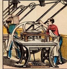
Cette poussière de graphite est mélangée en proportions variables, suivant le degré de dureté qu'on désire obtenir, avec de l'argile pulvérisée. La pâte ainsi composée est soumise à une machine qui la fait sortir sous forme de fil rond ou carré.
