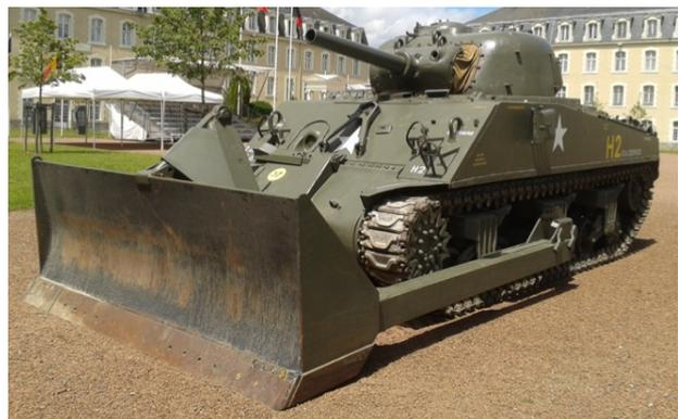
Le Sherman est un modèle M4 à caisse angulaire soudée fabriqué par *Chrysler Corporation* en 1944, identifiable par son blindage frontal lisse, relevé à 47°, sans avancée du poste de pilotage et du poste mitrailleur.
