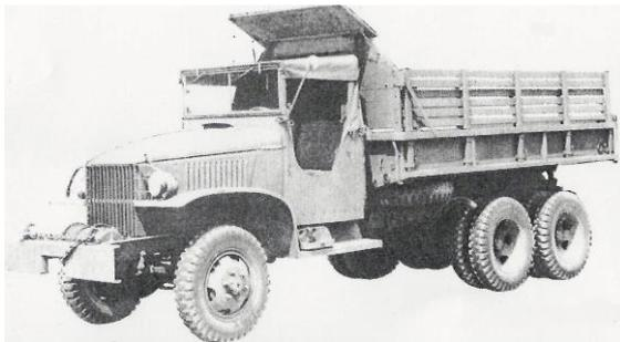
La particularité du GMC benne qui se rencontre avec ou sans cabine tôle, avec ou sans treuil, est sa benne basculante fabriquée par *Gar Wood Industry* ou *The Heil Company*. Activée par un vérin hydraulique, la benne est aisément identifiable par ses supports d'arceaux en forme de cavalier, ses 3 panneaux latéraux et l'absence de garde-boue à l'arrière. Une protection en bois avec déflecteur est fixée derrière la cabine.
