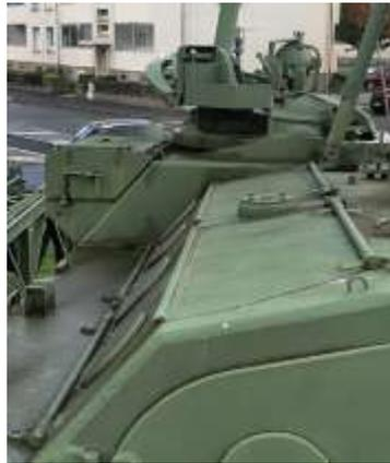
A droite, le chef de groupe également chef d'engin dispose d'une trappe d'accès par le toit. Il dispose de 3 épiscopos (non visibles sur la vue).
