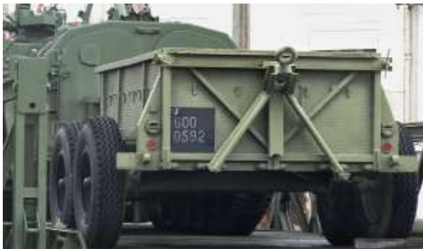
Le VCG tracte une remorque spéciale ARE M<sup>le</sup> F1 à deux essieux de deux tonnes de charge utile, servant, en particulier, au transport des explosifs et des outils. Cette dernière a des pneus increvables et peut être décrochée automatiquement de l'intérieur de l'engin grâce à un crochet de traction à ouverture commandée. Elle est aussi amphibie si sa charge n'excède pas 640 kg. En pratique, la remorque ARE est rarement employée.
