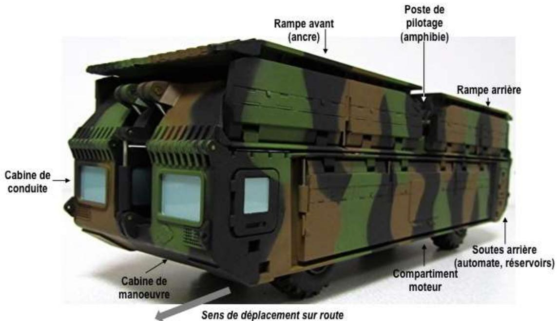
L'EFA est équipé d'une boîte automatique à 6 vitesses (les 3 premières vitesses peuvent être actionnées manuellement si besoin), ainsi que 4 roues à directions assistées.
