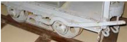
Il est présenté sur un élément de voie étroite (60 cm) Decauville avec un caisson pour munitions de 75 mm. (capacité d'emport : 2 caissons).
