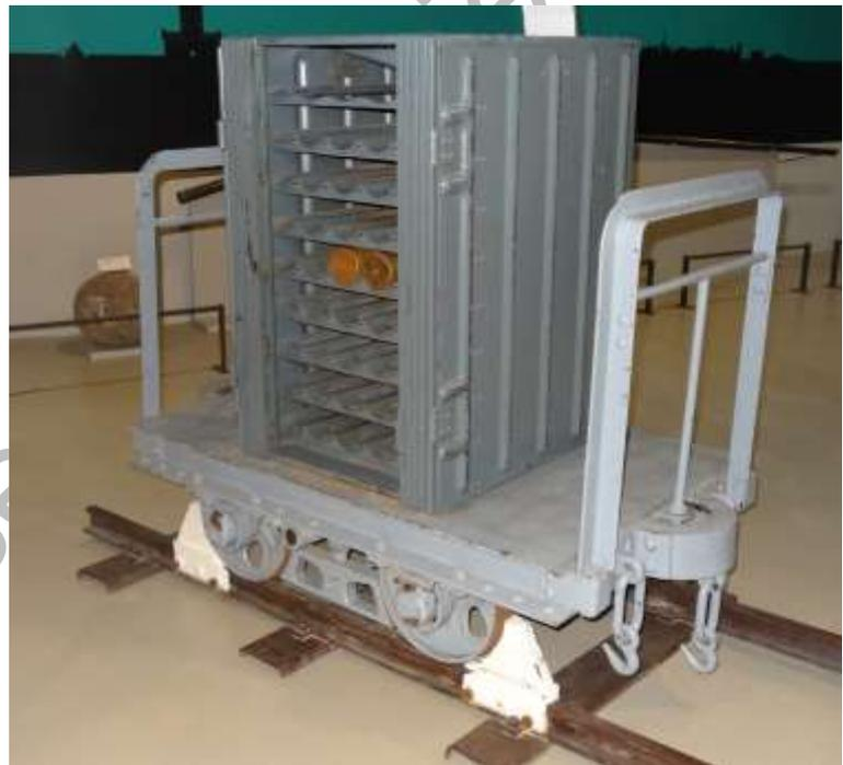
Le **caisson** métallique permet de transporter 45 obus de 75 mm jusqu'aux pièces à poste dans les blocs de combat. Il est fermé de chaque côté par deux grilles métalliques articulées (ici en position ouverte)
